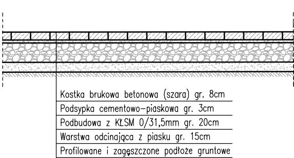
ZJAZD INDYWIDUALNY – PRZEKRÓJ KONSTRUKCYJNY
